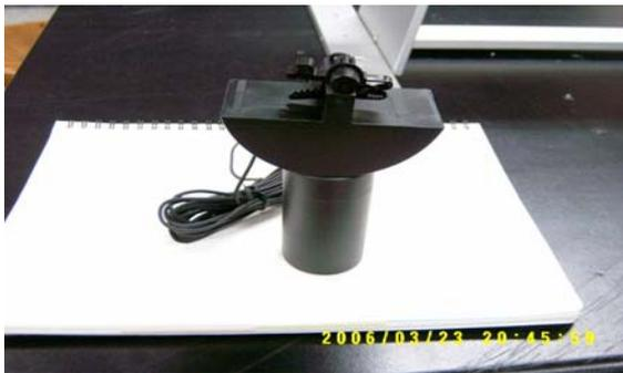
그림 2. 마이크와 지지대 및 용기 밖에 설치될 손잡이가 부착된 모습
